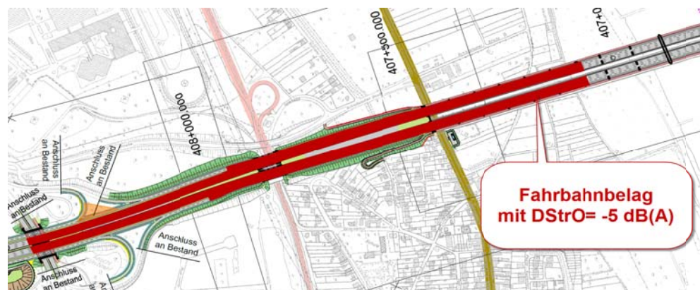
Abb. 14 Fahrbahnbelag mit D_{StrO} = -5 \text{ dB(A)} linksrheinisch
